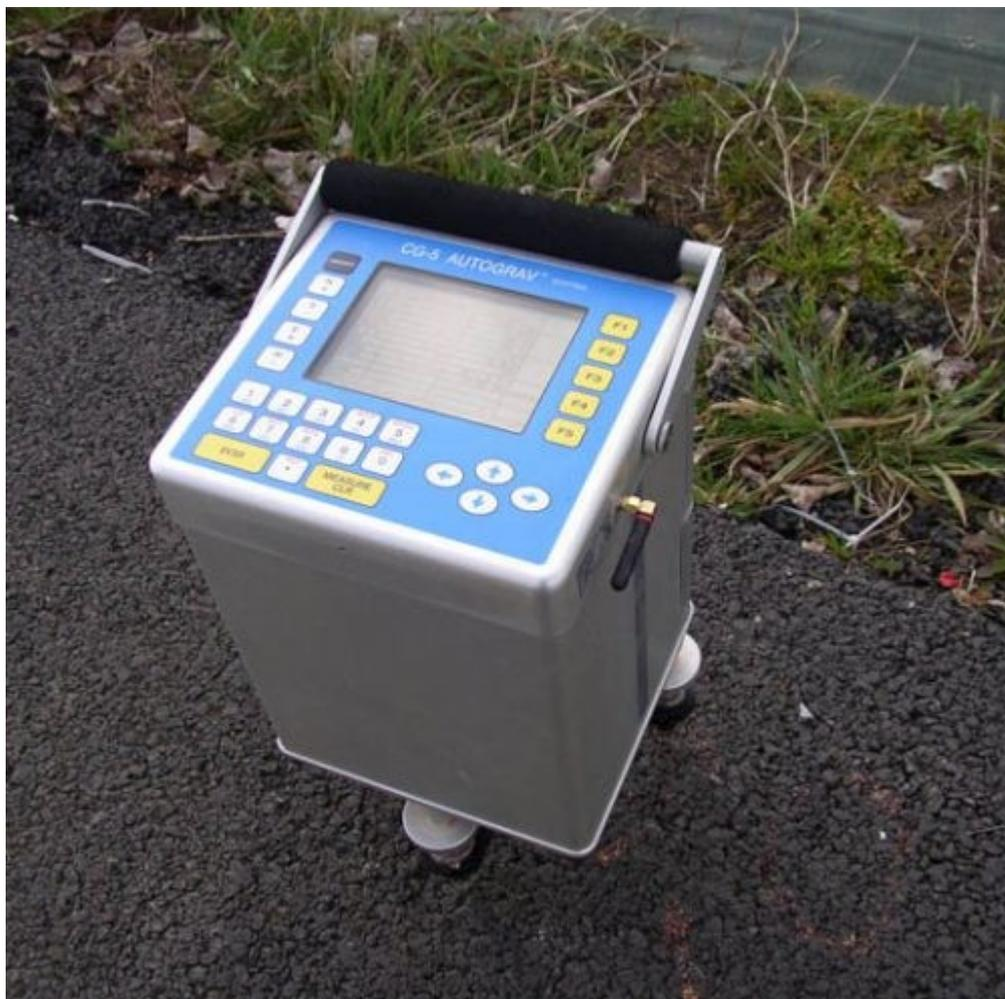
**Figura 3:** Gravímetro relativo da marca Scintrex modelo CG-5
