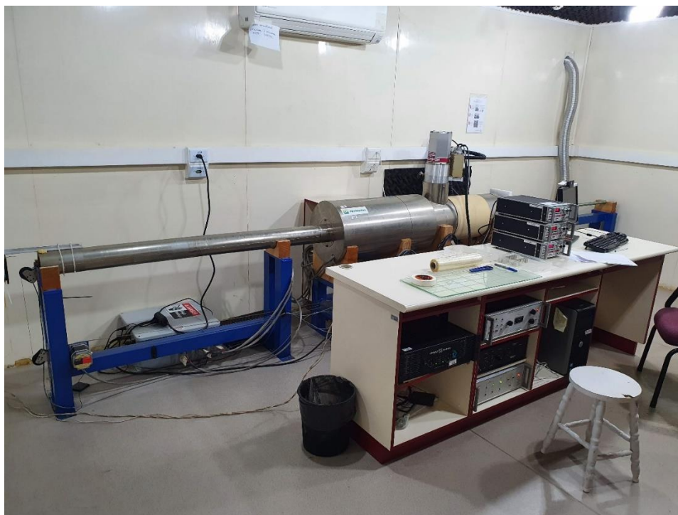
Figura 1.11. Magnetômetro de três eixos 2G Enterprises modelo 755 SQUID localizado na sala blindada do USPMag.
