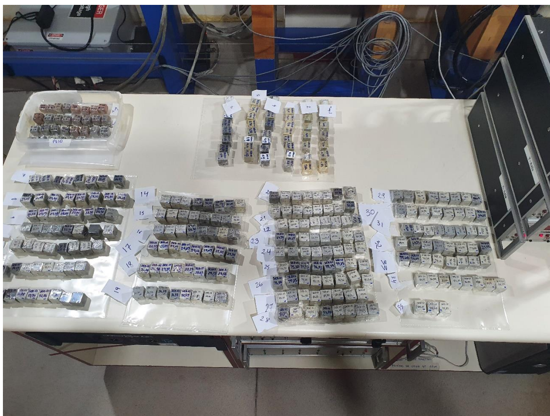
Figura 1.9. Amostras cúbicas de 8 cm 3 do testemunho SER-01.
