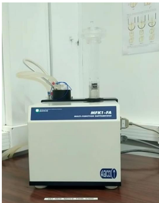
Figura 1.10. Susceptibilímetro MKF1-FA Multi-Function Kappabridge , localizado no USPMag, onde as medidas de susceptibilidades magnéticas das amostras foram realizadas.
