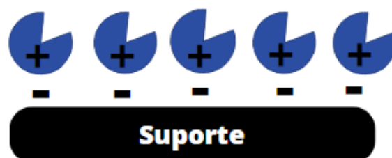
Figura 9. Imobilização por ligação iônica, o suporte e a enzima necessitam estar com cargas opostas.
