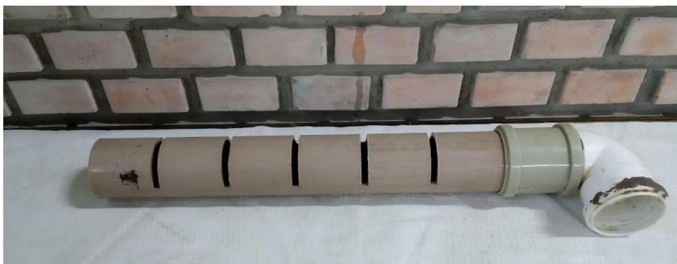
Figura 36: Tubo ranhurado construído com tubos de PVC DN75.
