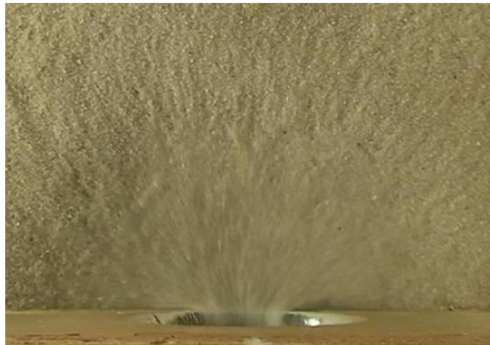
Figura 10: Princípio da erosão por descarga pressurizada (Fonte: Powell e Khan (2012)).
