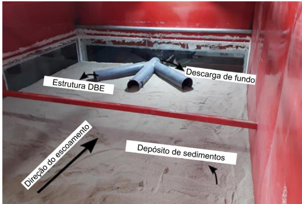
Figura 18: Descarga de fundo DBE e a cava de erosão sua operação gera (Fonte: adaptado de Haghjoui et al. (2021)).
