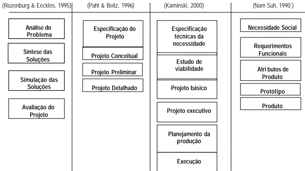
**FIGURA 2: Exemplos de modelos de fases do Processo de Desenvolvimento de Produtos por autores de Engenharia**
