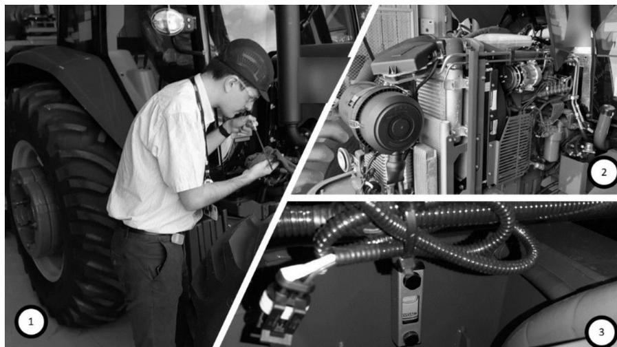
Figura 5 – Verificação do nível de óleo do motor (1), verificação do nível do líquido de arrefecimento (2) e verificação do nível de óleo da transmissão (3).
