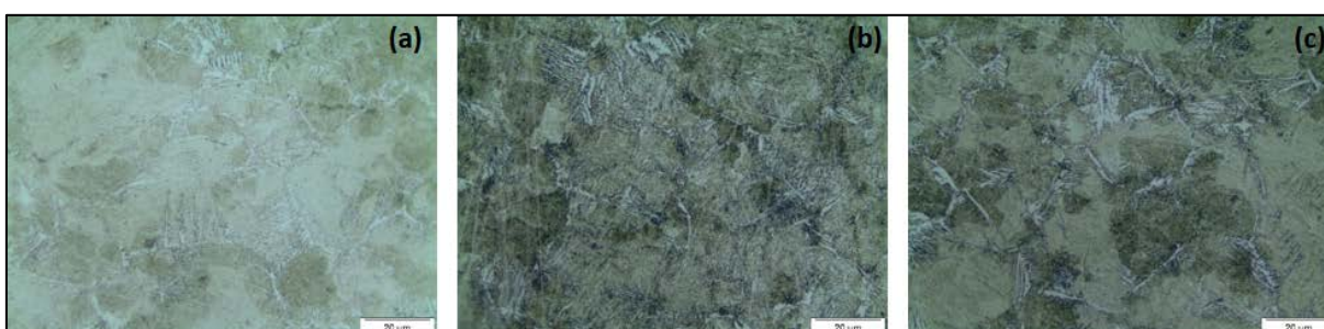
Figura 48 – Micrografia Aço SAE 1045 aumentado de 1000x. em diferentes amostras: (a) pino 1, (b) pino 2, (c) pino 3.
