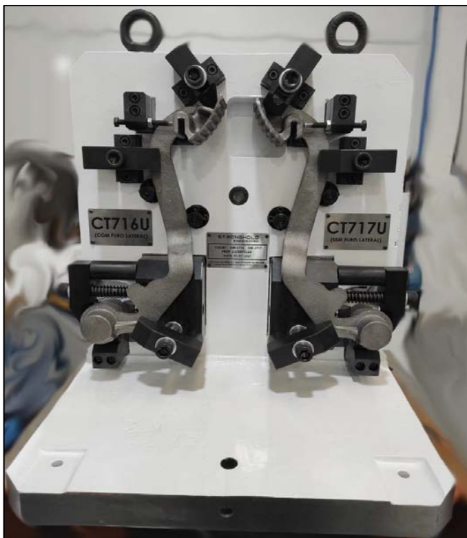
Figura 16 – dispositivo para usinagem do pedal de freio.
