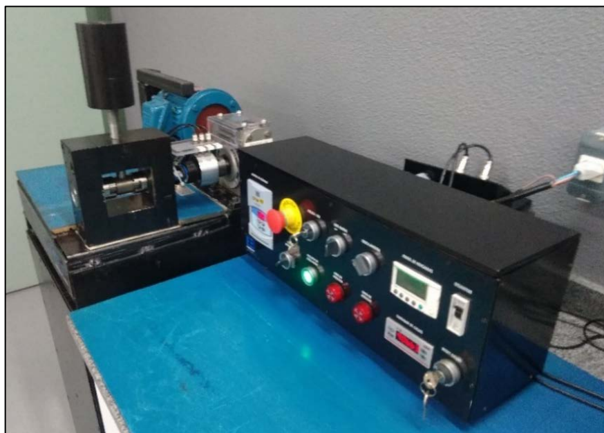
Figura 28 – Tribômetro desenvolvido no Programa de Pós-Graduação em Tecnologia e Engenharia de Materiais PPG-TEM
