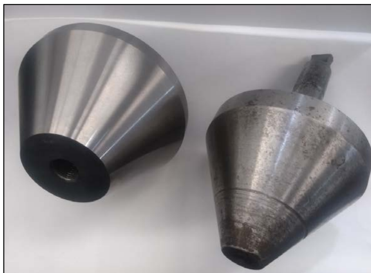
Figura 25 – Contra-pontos nas condições (a) novo (b) usado.
