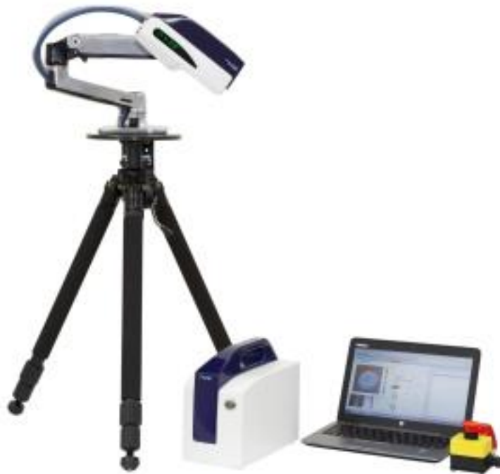
Figura 17 – Equipamento portátil de medição de tensões residuais baseado na técnica de difração de raios X.
