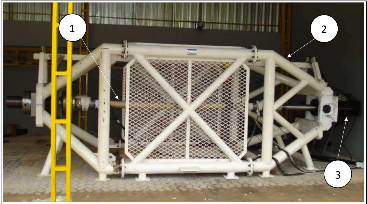
Figura 22 – Bancada utilizada no ensaio experimental, onde: (1) Amostra de duto flexível de 2,5" com conectores nas extremidades; (2) Bancada utilizada no ensaio; (3) Atuador hidráulico.
