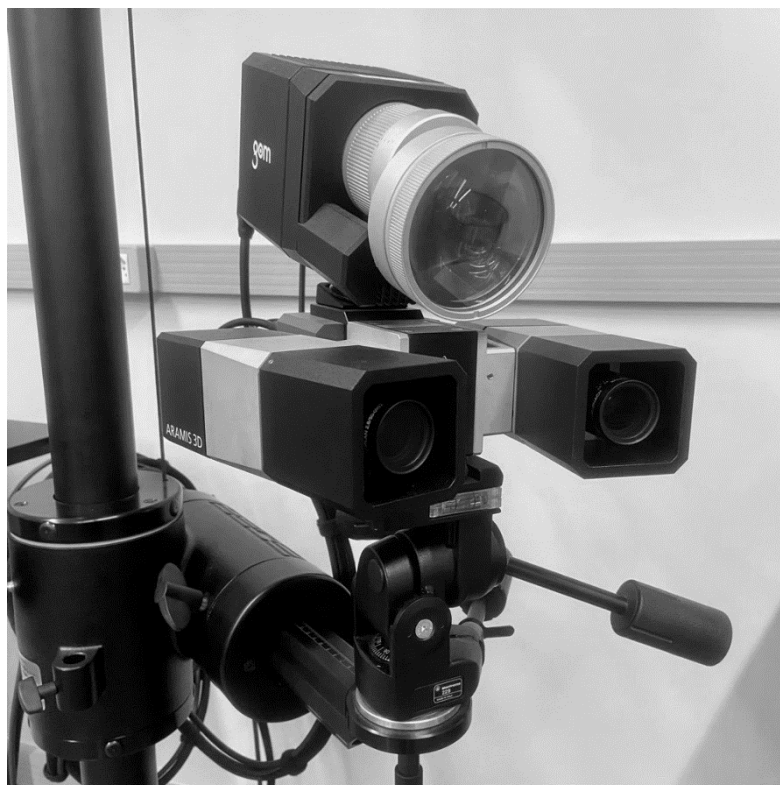
Figura 4.9 Equipamento GOM-ARAMIS com duas câmeras de 6M. Fonte: a Autora.
