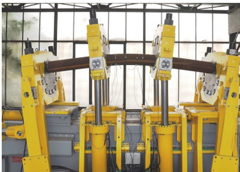
Figura 3.4 Montagem de estrutura para realização de simulação do efeito do reeling em escala real (FSR). Fonte: Mannesmann Line Pipe, 2023. Disponível em: < https://www.mannesmann-linepipe.com/en/processes/tests.html >. Acesso em: 15/12/2023.
