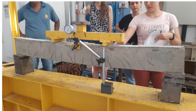
Figura 14. Detalhe de fissuras por flexão.
