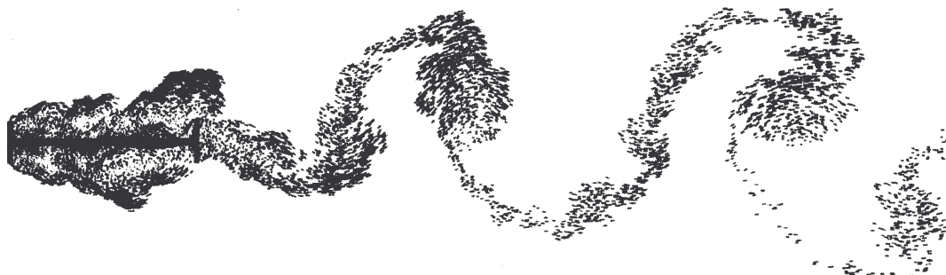
Fig. 2.14 – Formação da esteira de vórtices de von Kármán na excitação da seção transversal H (Larsen, 1998).
