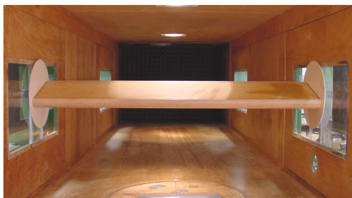
Fig. I.4 – Modelo V: vista do modelo no interior do túnel de vento.
