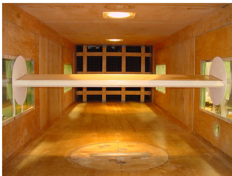
Fig. 3.8 – Modelo II: vista interna do túnel de vento e o modelo posicionado na mesa M-I com a grelha G-I (que simula turbulência) ao fundo.
