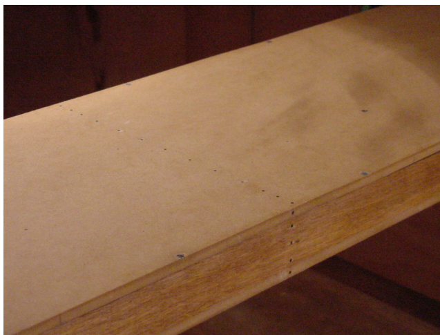
Fig. 3.6 – Modelo I: foto da seção com foco na distribuição das tomadas de pressão.
