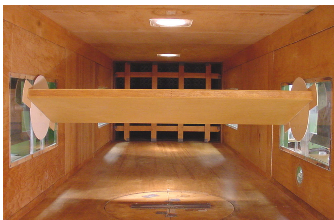
Fig. I.5 – Modelo VII: vista interna do túnel de vento e o modelo posicionado na mesa M-I com a grelha G-I (que simula turbulência) ao fundo.
