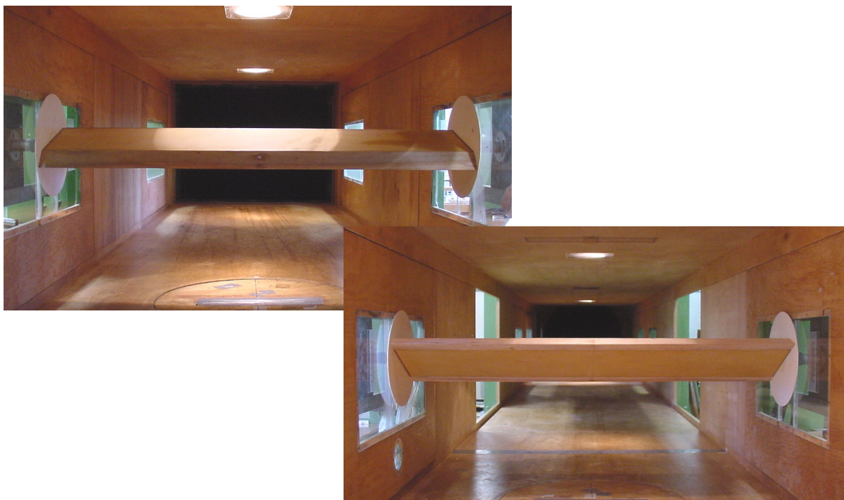
Fig. I.3 – Modelo IV: vista interna do túnel de vento. Acima: modelo visto de cima. Abaixo: modelo visto de baixo.
