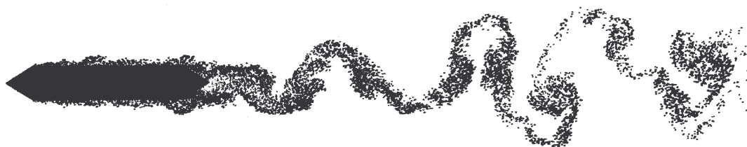
Fig. 2.15 – Formação da esteira de vórtices de von Kármán na excitação da seção transversal B (Larsen, 1998).
