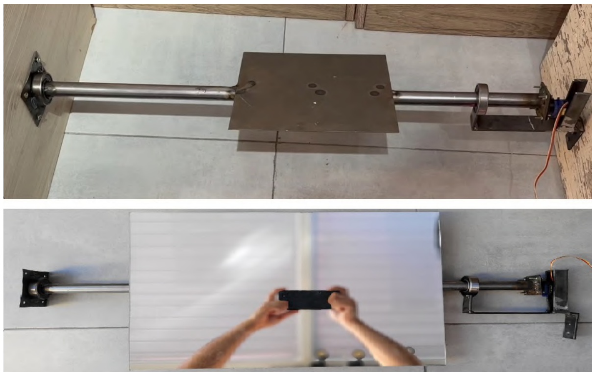
Figura 15: Na imagem superior, a estrutura encontra-se montada com o servo motor, conectada em dois pedaços de madeira para simular a caixa. Na imagem inferior, a estrutura está montada com o servo motor e o espelho.
