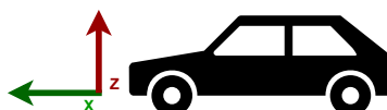
Figura 15: Posição dos eixos X e Z do acelerômetro em relação ao veículo.
