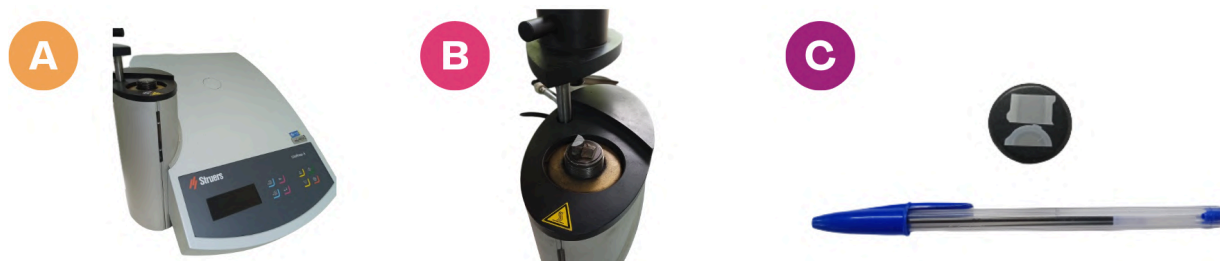
Figura 11 – Processo de embutimento a quente da amostra
