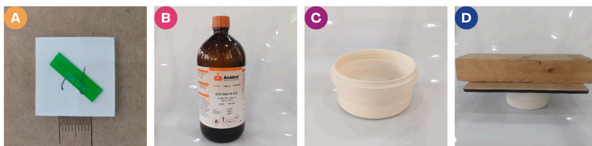
Figura 27 – Estrutura utilizada para realização do acabamento na impressão FDM - ABS
