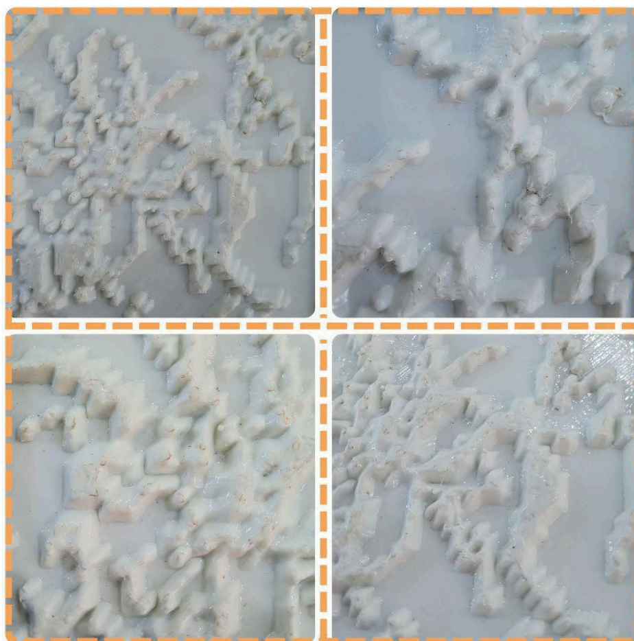
Figura 29 – Registros macro da peça após passar 30 min pelo vapor de acetona para acabamento da impressão
