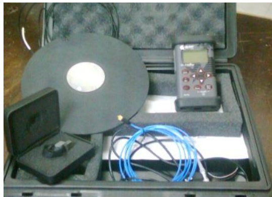
Figura 2.5 – Medidor VI400-Pro e transdutores utilizados nas medições.
