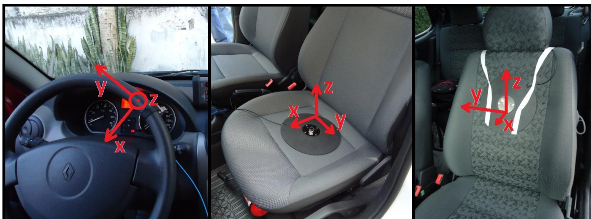
Figura 2.8 – Acoplamento dos respectivos transdutores no volante, assento e encosto juntamente com o sistema de coordenadas adotado.
