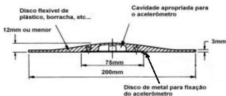
Figura 2.6 – Corte do seatpad conforme projeto da SAE (Fonte: GRIFFIN, 1990).
