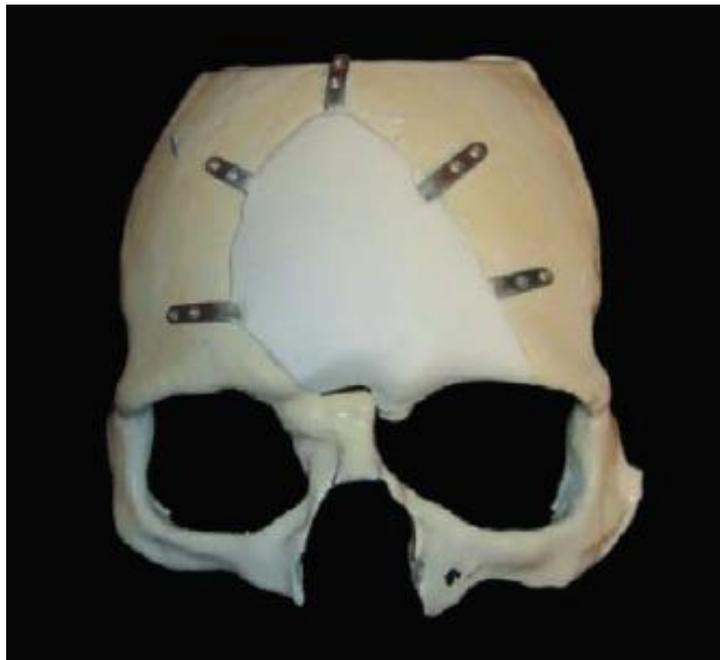
Figura 11: Implante de  $\alpha$  – TCP reforçado com titânio.
