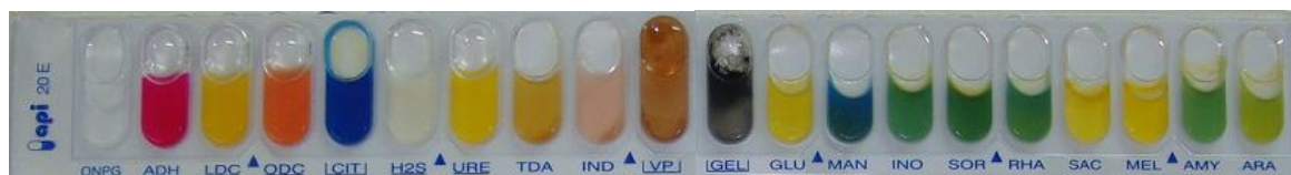
FIGURA 29. Aspecto visual do teste API 20e para identificação do isolado bacteriano IB2, obtido em tecido de hastes de gérbera. Porto Alegre, 2011.
