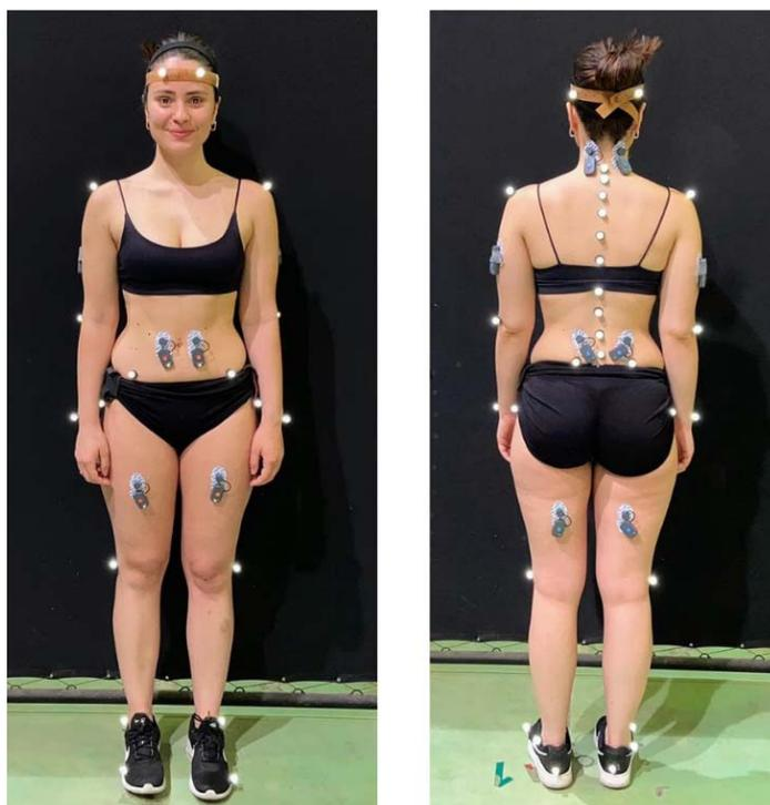
**Figura 4: Posições dos eletrodos e marcadores reflexivos no participante- porção anterior e posterior.**
