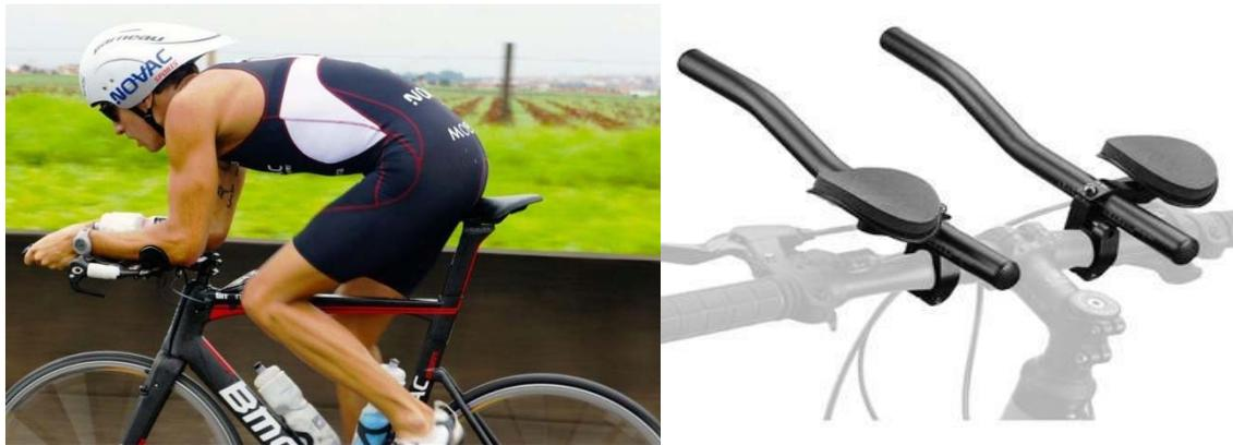
**Figura 2: Clip de guidão ou Aerobar.**
