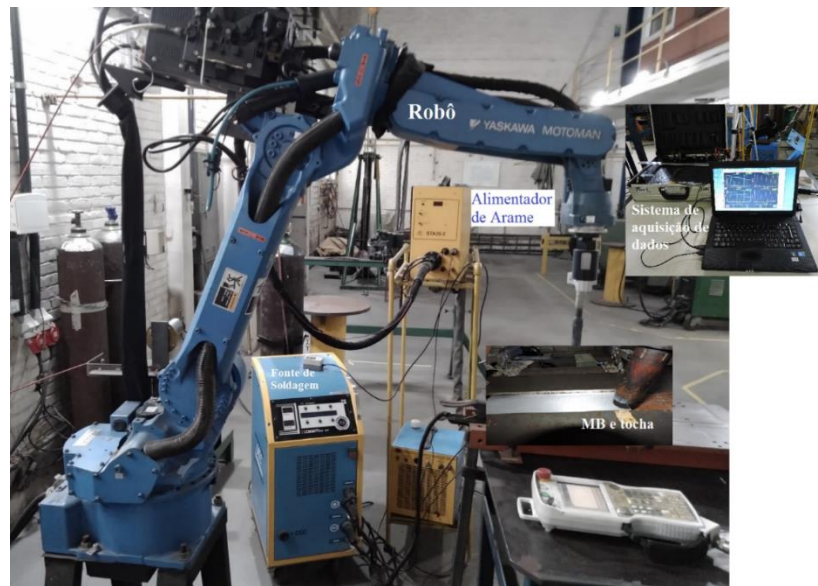
Figura 4.1 – Equipamentos de soldagem à esquerda, robô Motoman o e equipamentos de aquisição de dados, a fonte de soldagem IMC e o alimentador de arame.
