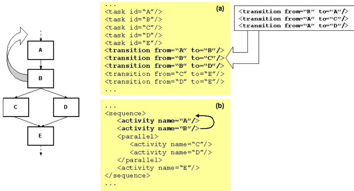
FIGURA 3.16 – Facilidade de alteração de esquema de workflow de acordo com a linguagem de representação
