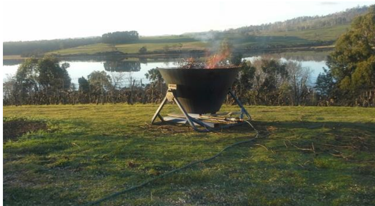
Figura 6: Forno Kon-Tiki para produção de biochar.
