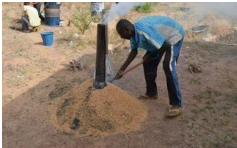
Figura 5: Demonstração do equipamento adaptado de produção de biochar chamado “retorta aberta do Japão”.
