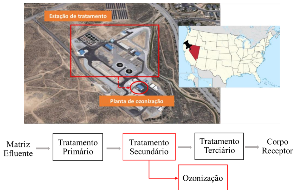
Figura 22. Fluxograma e localização da planta piloto em Reno-Stead Water Reclamation Facility (RSWRF), Reno – NV, Estados Unidos.
