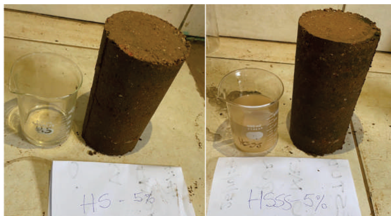
Figura 54. Moldagem dos corpos de prova.
