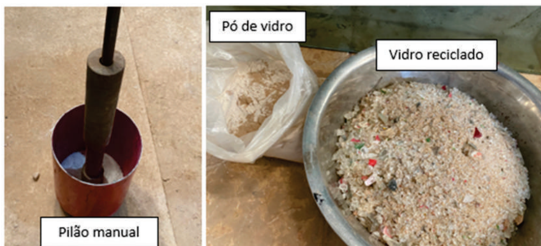
Figura 49. Pilão manual para moagem do vidro reciclado.
