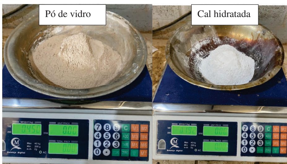
Figura 56. Preparo do precursor do cimento alternativo (pó de vidro + cal hidratada).
