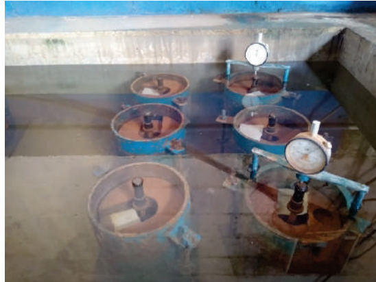
Figura 44. Ensaio de compactação realizado (fase de expansão).
