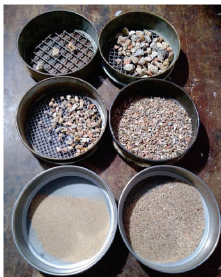
Figura 57. Material retido após a lavagem.
