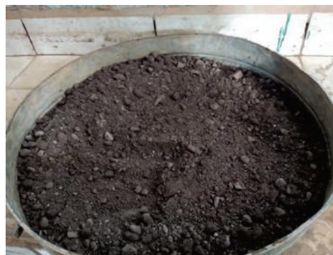
(b) Homogeneização da mistura (solo + cimento)
