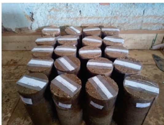
Figura 46. Corpos de prova moldados para ensaio de compressão simples.
