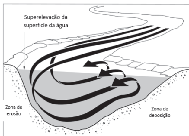
Figura 5. Erosão e deposição causadas por ação hidráulica.
