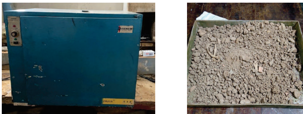
Figura 42. Material reciclado após 24h na estufa.
