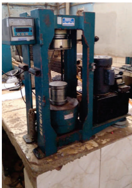
Figura 47. Prensa eletro hidráulica digital utilizada.
