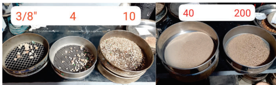
Figura 78. Material retido após a lavagem nas diferentes peneiras.
