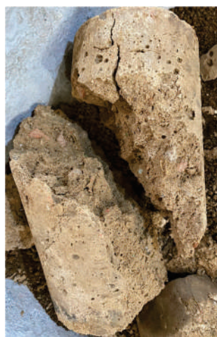
Figura 81. Corpo de prova PVCH+5HSSS (15%), que se quebrou ao ser desmoldado.
