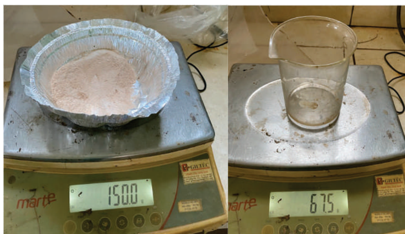
Figura 53. Preparo do cimento alternativo (pó de vidro + ativadores).
