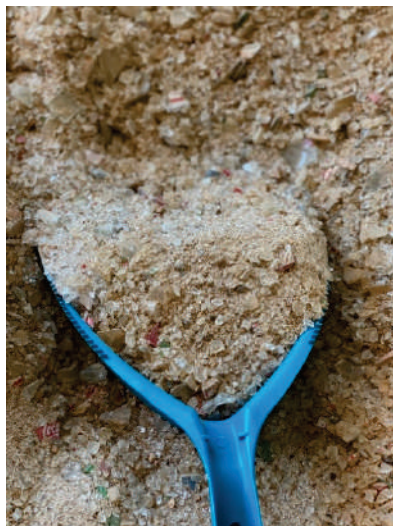
Figura 48. Vidro moído reciclado coletado na usina de reciclagem.
