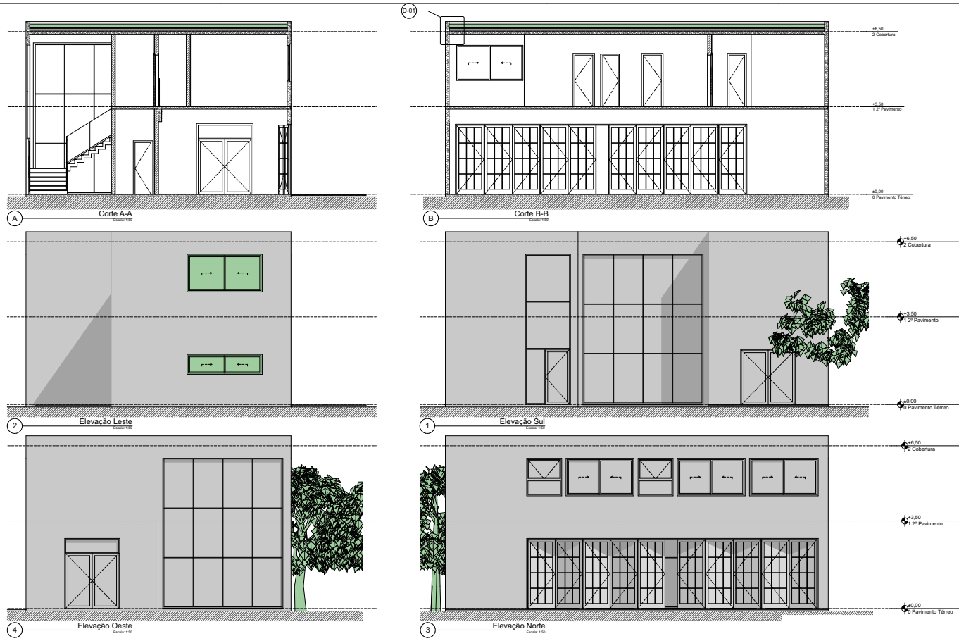
Figuras 08 e 09 (acima) Cortes A-A/B-B e Elevações referentes ao Exercício 03, com destaque em verde para os elementos alterados ou adicionados ao modelo original.
