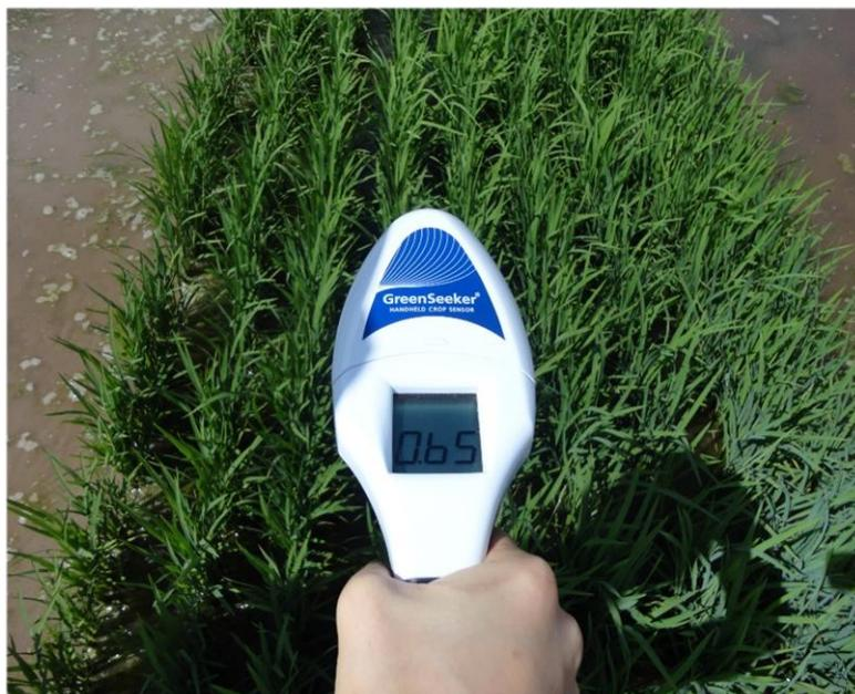
FIGURA 2. Realização da leitura do NDVI em arroz utilizando o aparelho *Greenseeker*<sup>®</sup>.
