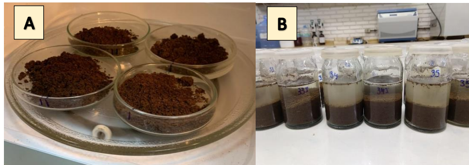
Figura 8. Amostras sendo irradiadas (A) em forno micro-ondas e decantando (B) para realizar análise de carbono da biomassa microbiana do solo (C-BMS) e nitrogênio da biomassa microbiana do solo (N-BMS). Foto: Autoria própria.
