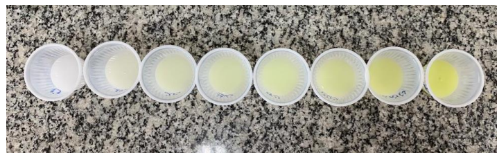
Figura 13. Solução contendo a concentração de 0, 10, 20, 30, 40 e 50 \mu g de p -nitrofenil (PNF) para fazer a curva padrão que posteriormente foi usada para a equação no cálculo de atividade enzimática da \beta -glicosidase. Laboratório de Microbiologia e Bioquímica da UFLA, Lavras - MG. Foto: Autoria própria.
