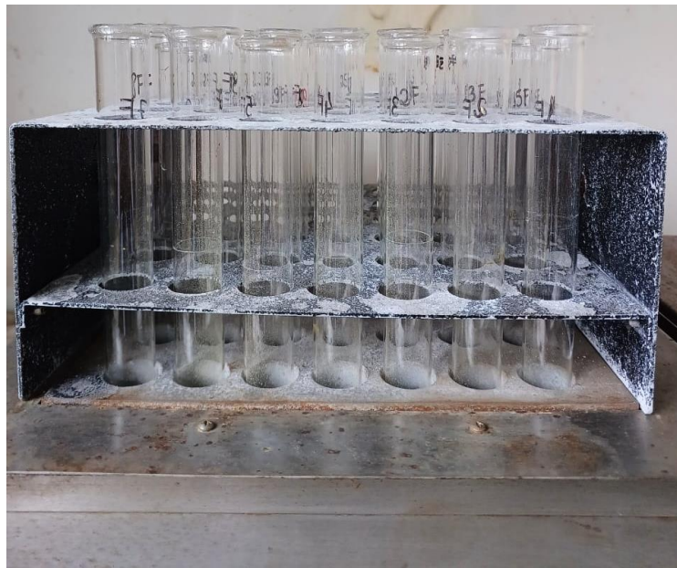
Figura 10. Amostras para determinação de nitrogênio da biomassa microbiana do solo, no bloco digestor. Laboratório de Química do Solo da UFRGS, Porto Alegre-RS. Foto: Autoria própria.
