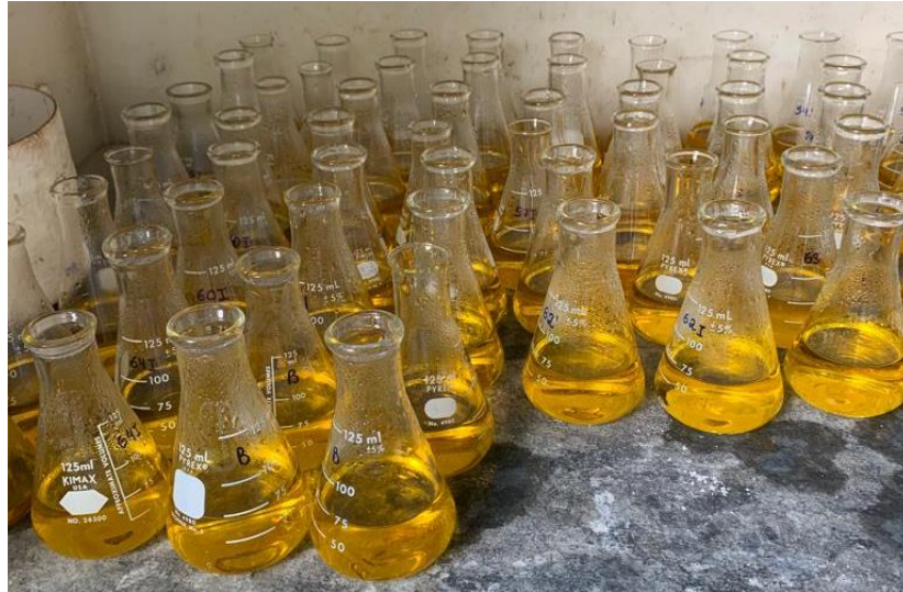
Figura 9. Amostras para determinação de carbono da biomassa microbiana do solo, após a adição de K_2Cr_2O_7 , H_2SO_4 e água destilada. Laboratório de Química do Solo da UFRGS, Porto Alegre – RS. Foto: Autoria própria.
