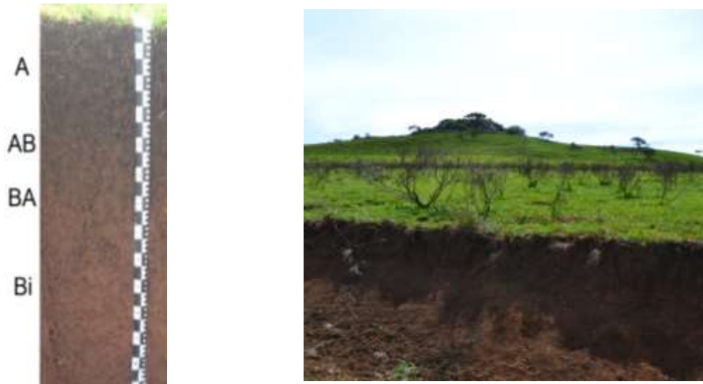
Figura 11. Perfil 01 - CAMBISSOLO HÁPLICO Tb Aluminoso típico e paisagem da área de ocorrência.
