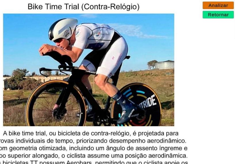
A bike time trial, ou bicicleta de contra-relógio, é projetada para provas individuais de tempo, priorizando desempenho aerodinâmico. Com geometria otimizada, incluindo um ângulo de assento íngreme e tubo superior alongado, o ciclista assume uma posição aerodinâmica. As bicicletas TT possuem Aerobars, permitindo que o ciclista apoie os
