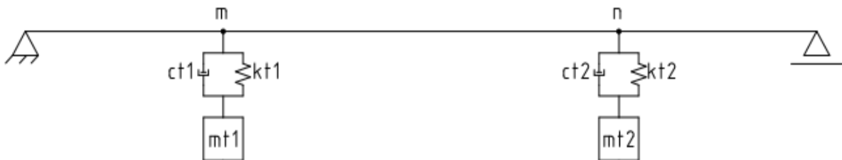
Figura 3.12 – Estrutura com dois TMD's instalados
