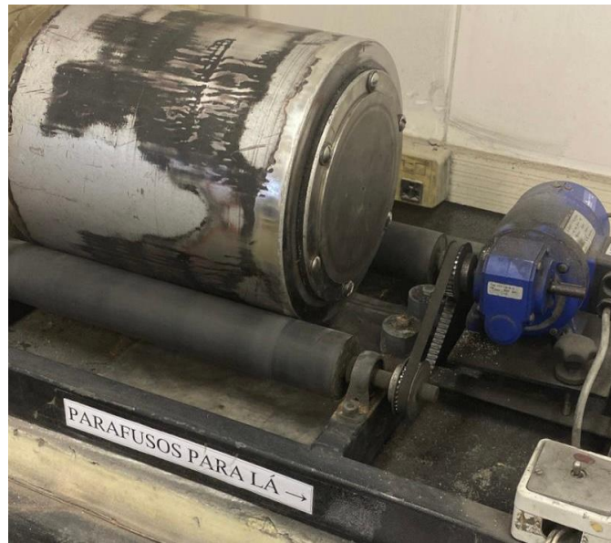
Figura 25 - Moinho de Bolas utilizado para a moagem da CCA
