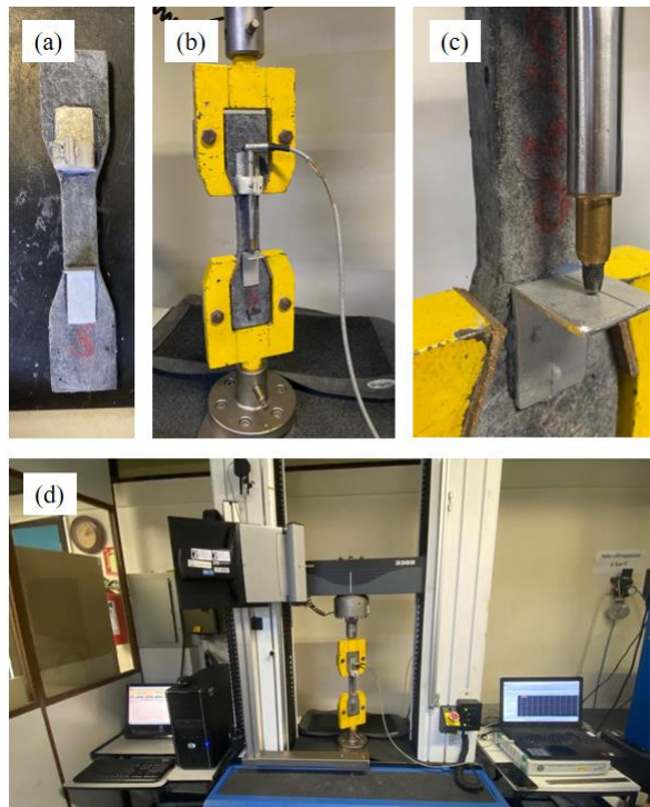
Figura 41 - Execução do ensaio de tração direta
