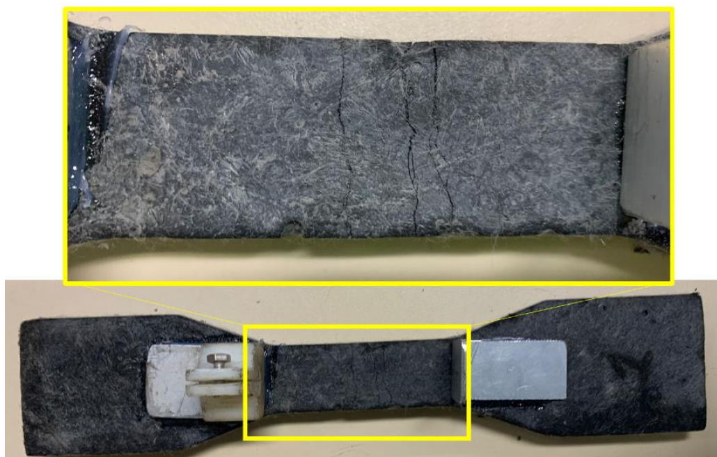
Figura 58- Situação após ensaio do corpo de prova submetido à tração – verificação das fissuras na alma (amostra CP1 CCA50)
