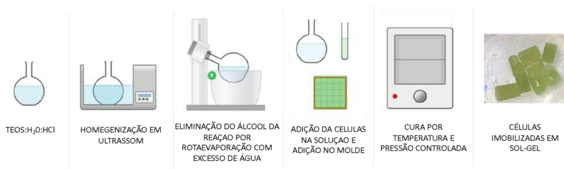
Figura 2.10. Metodologia de sol-gel por evaporação do álcool gerado
