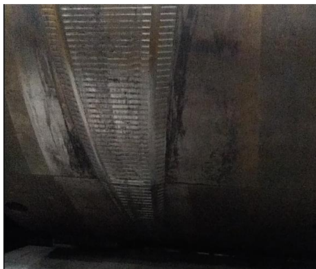
Figura 56 – Serrilhas na superfície do Rolo Laminador
