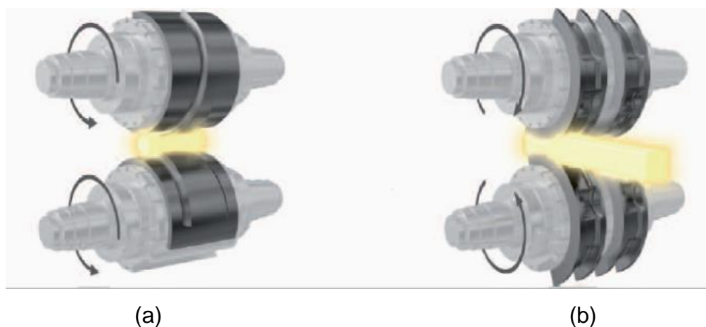
Figura 12 - Tipos de laminação para obtenção de pré-forma, transversal (a) e longitudinal (b) [13]
