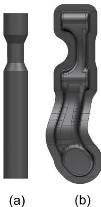
Figura 4 – Pré-forma laminada (a) e forja final (b)
