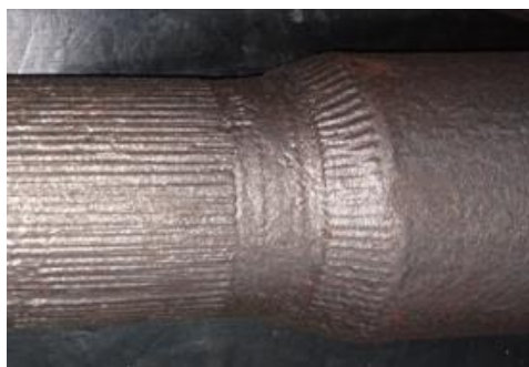
Figura 57 - Marcas das serrilhas na pré-forma laminada
