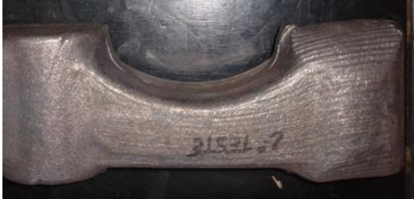
Figura 58 - Marcas das serrilhas no produto forjado
