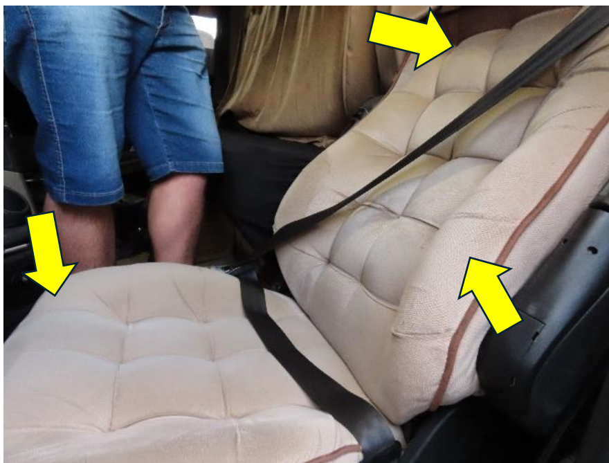
Figura 24 – Interior da cabine do caminhão de EC6 (motorista empregado de motorista autônomo). Cabine espaçosa. Insuflamento pneumático do assento pode ser feito em todo o assento, de forma independente (setas).
