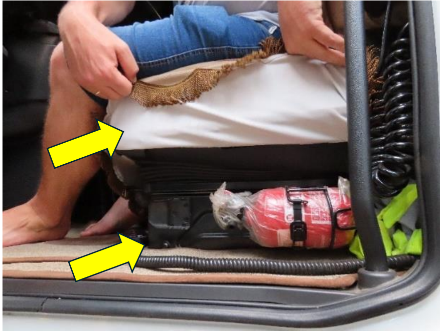
Figura 23 – Caminhão de EC6 (motorista empregado de motorista autônomo). Base do assento com várias possibilidades de ajustes e sistema amortecedor contra VCI e vibração de impacto.
