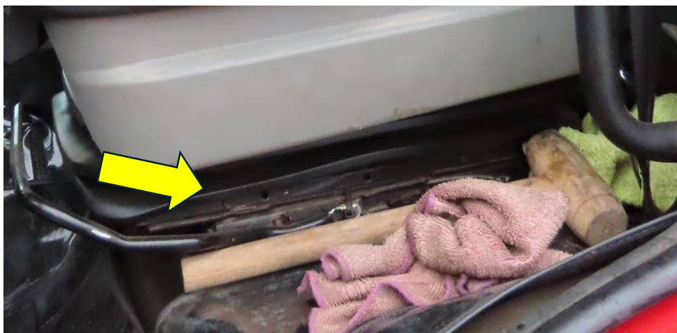
Figura 13 – Caminhão de EC2 (motorista empregado de CD): Comando de ajustes do assento quebrado.
