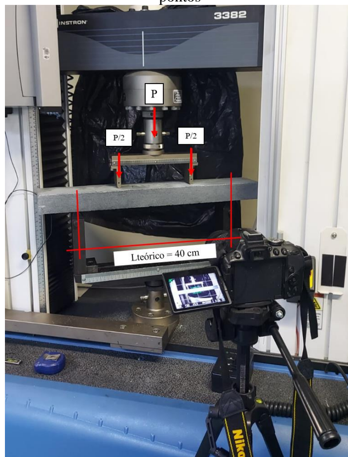
Figura 98 - Layout para captura de dados através da DIC para os testes à flexão a quatro pontos
