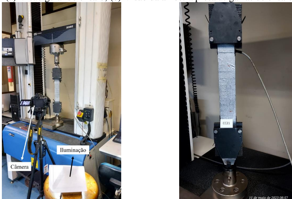
Figura 89 - Layout para captura do campo de deformações através da metodologia DIC; (a) Visão geral do ensaio; (b) Visão da amostra presa às garras de ensaio
