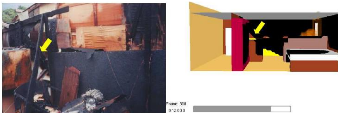
Figura 2 - Marcas decorrentes do incêndio e decorrentes da simulação computacional
