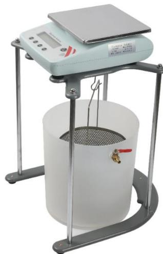
Figura 4.3 – Balança hidrostática [fonte: Internet]
