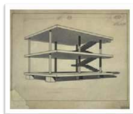
Figura 1-54: Maison Dom-Ivo, desenvolvida em conjunto com o engenheiro Max du Bois, em 1914. Fonte: FONDATION LE CORBUSIER.
