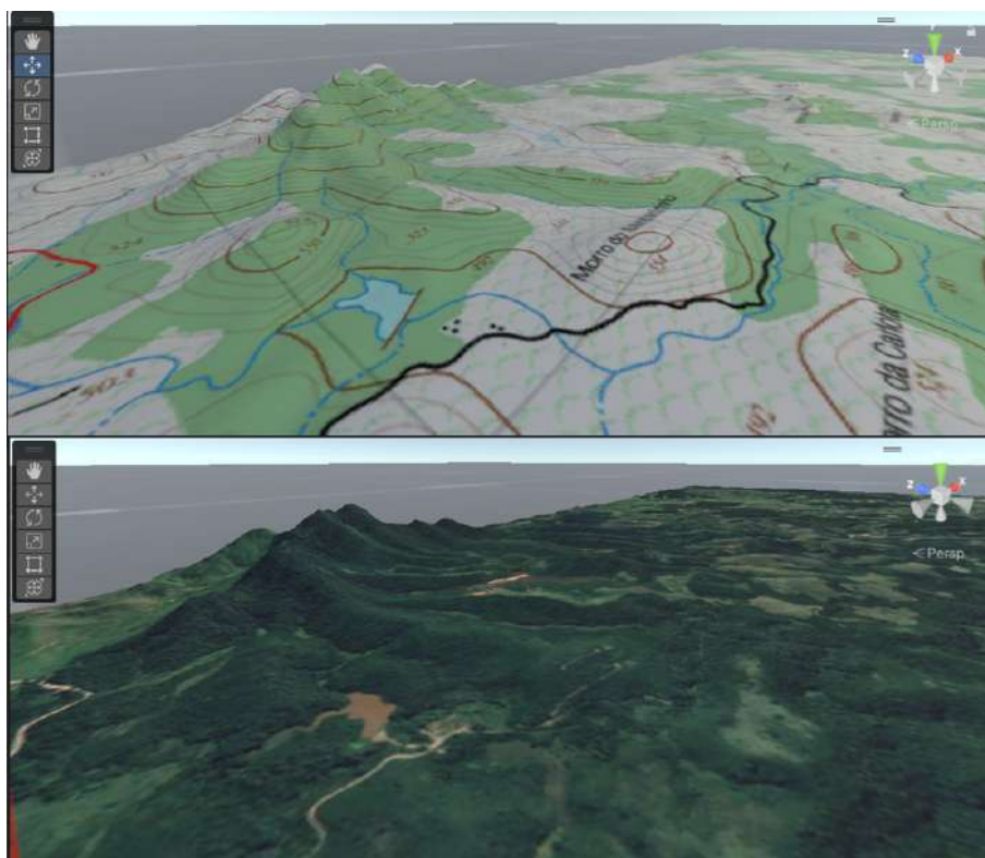
Figura 3.4 – O terreno digital com seu relevo reproduzido em 3D, na figura superior com a textura da carta topográfica e na figura inferior com a textura da imagem de satélite
