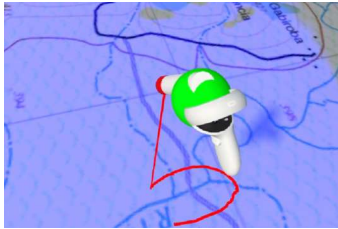
Figura 3.11 – Visualização do raio utilizado para guiar a direção do desenho sob a textura do relevo digital
