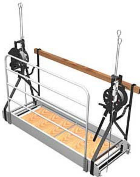
Figura 14: Andaime suspenso leve com plataforma de trabalho, guarda-corpo e corrimão. As plataformas podem ser metálicas (2 e 3 m) ou de madeira (2, 3 e 4 m).
