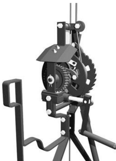
Figura 21: Guinchos incorporam múltiplo sistema de segurança composto de trava externa, bloqueamento da manivela de acionamento, conjunto rosca sem-fim/coroa autotravante e dispositivo trava-quedas. Quatro cabos de aço complementam os sistemas de segurança do equipamento.
