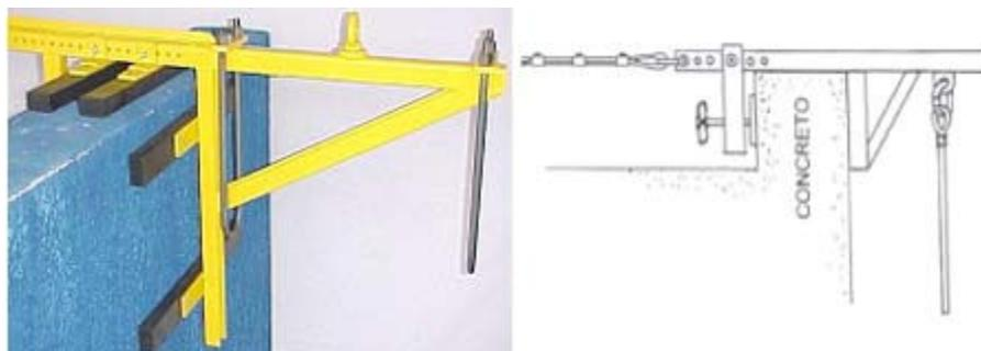
Figura11: Exemplo de fixação de estruturas de apoio em platibanda
