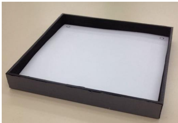
Figura 6. Exemplo de caixa para vedação da luz utilizada durante a aquisição das imagens.
