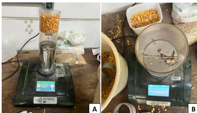
Figura 5: Análises de umidade e impurezas. A) Determinador semiautomático de umidade de grãos. B) Determinação do teor de impurezas dos grãos de milho.
