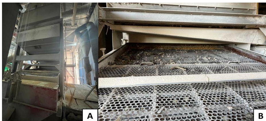
Figura 6: A) Máquina de Ar e Peneira (MAP) utilizada na limpeza dos grãos. B) Conjunto de peneiras utilizadas para a separação de impurezas da massa de grãos de milho.
