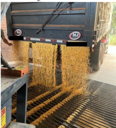
Figura 4: Descarregamento de milho úmido na moega.
