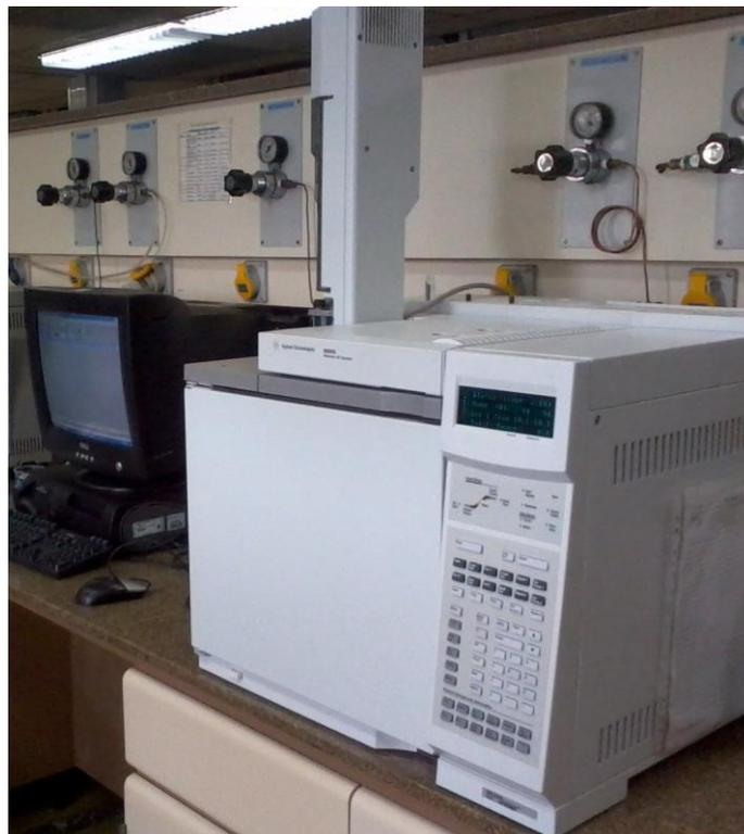
Figura 7: Cromatógrafo gasoso (GC) da marca Agilent.
