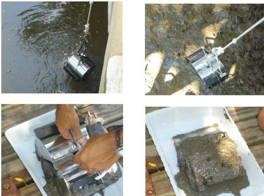
**Figura 11:** Ilustração do procedimento de coleta das amostras de sedimento com amostrador tipo Van Veen
