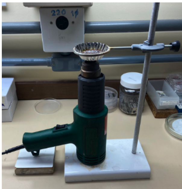
Figura 3.2: Processo térmico de solidificação do óleo.
