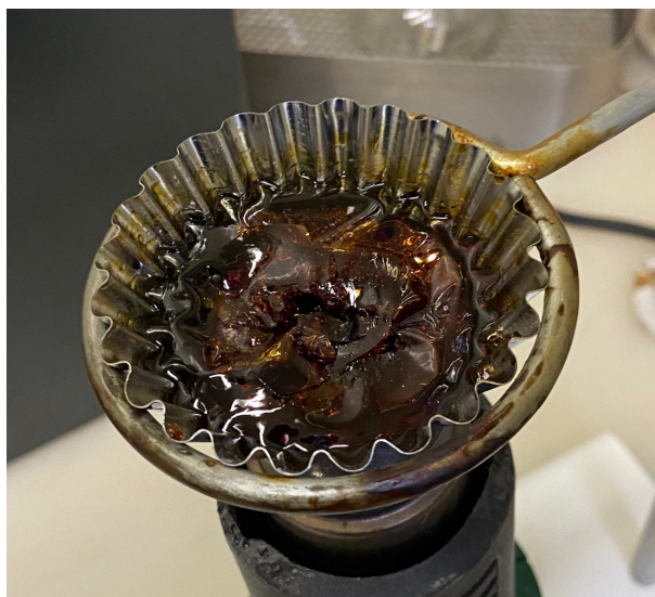
Figura 3.3: Amostra após 4-5 horas de tratamento térmico pronta para pastilhamento.
