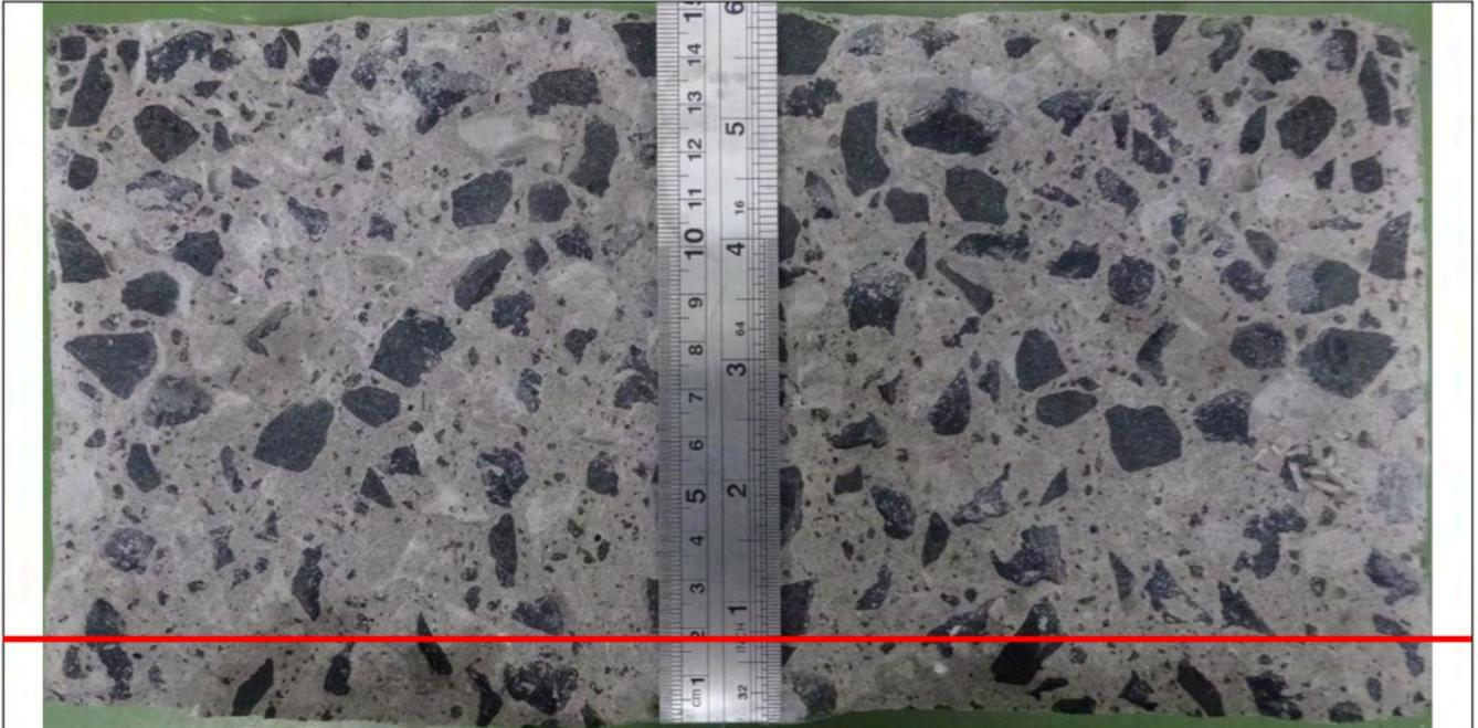
CP 3 traço XYPEX = penetração de água 18 mm.
