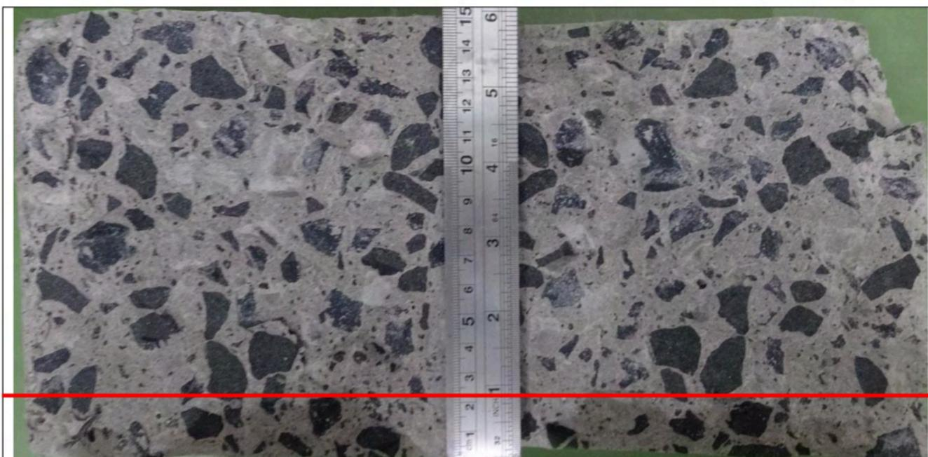
CP 2 traço XYPEX = penetração de água 21 mm.
