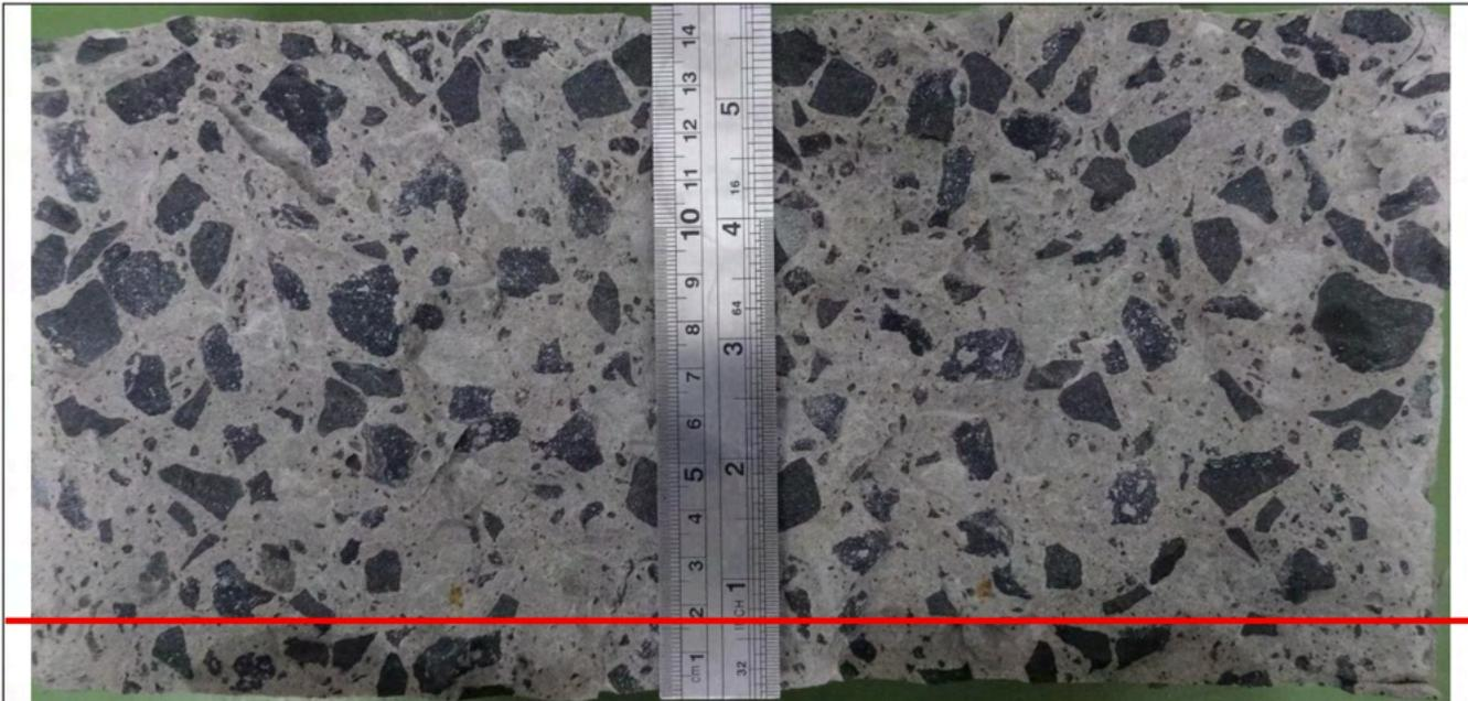
CP 2 traço PENETRON = penetração de água 16 mm.
