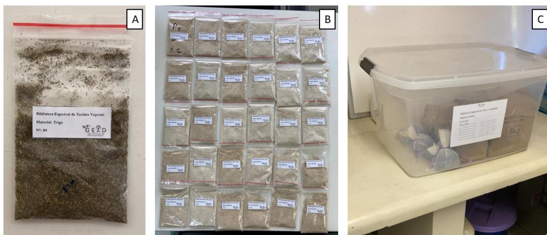
FIGURA 1. Amostras acondicionadas na Biblioteca Espectral de Tecido Vegetal (BETV). Sacos plásticos com lacre de vedação e identificação das amostras (A e B); Amostras armazenadas em caixas vedadas com controle de umidade (C).
