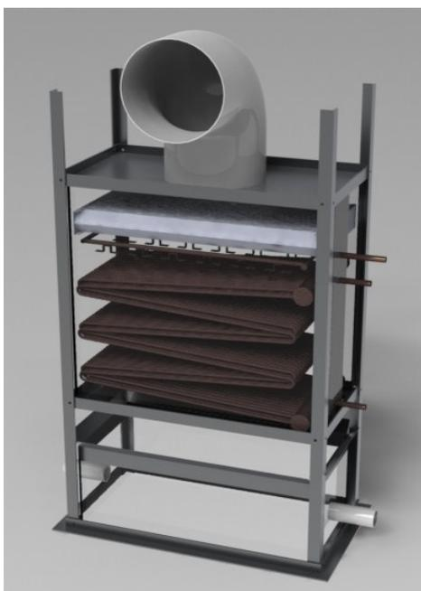
Figura 3.2 - Modelo virtual do condensador evaporativo [Walther, 2009]
