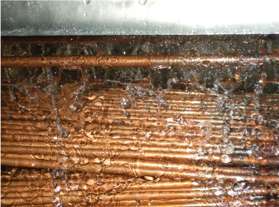
Figura 3.6 – Distribuidor de água com o sistema em operação
