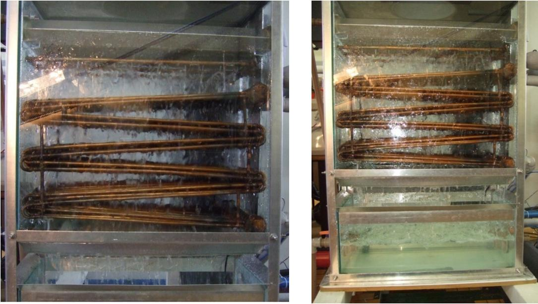
Figura 3.9 - Condensador evaporativo com aspersão de água
