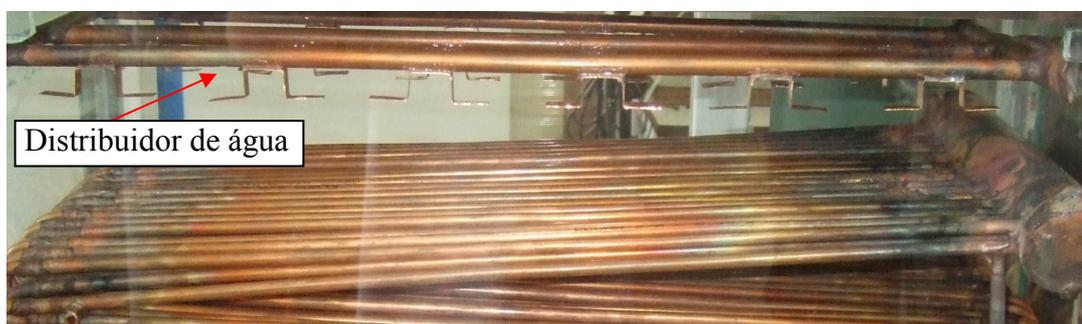
Figura 3.5 – Distribuidor de água com o sistema desligado
