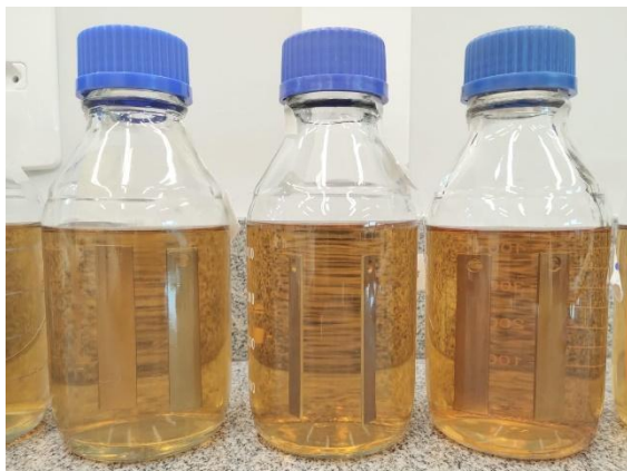
Figura 6 - Disposição dos cupons analisados em caldo TSB para verificação da taxa de biocorrosão por isolado representante das espécies analisadas no presente estudo.
