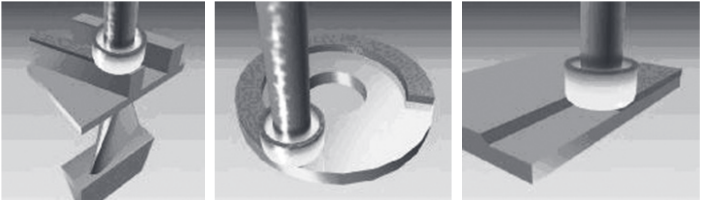
Figura 6. Desenho esquemático de alguns tipos de geometrias que podem ser recuperadas pelo processo de deposição por fricção [2].
