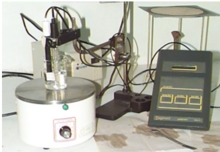
Figura 18 Medição da concentração de cloretos através do eletrodo de íon seletivo
