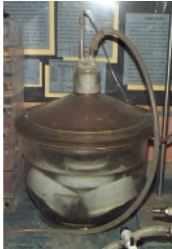
Figura 21 Corpos-de-prova submersos na água
