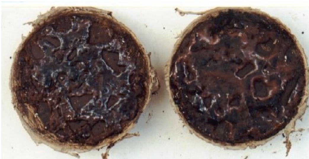
Figura 38 Visualização das faces dos corpos-de-prova expostas a água deionizada
