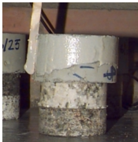
Figura 20 Impermeabilização das faces laterais do corpo-de-prova com resina epóxi
