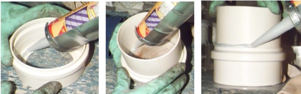
Figura 17 Vedação da célula positiva com poliuretano
