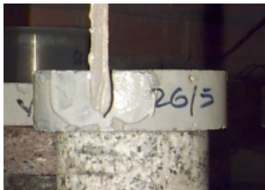
Figura 15 Revestimento do corpo-de-prova de concreto com resina epóxi
