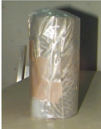
Figura 13 Aspecto do corpo-de-prova embalado em saco plástico para cura
