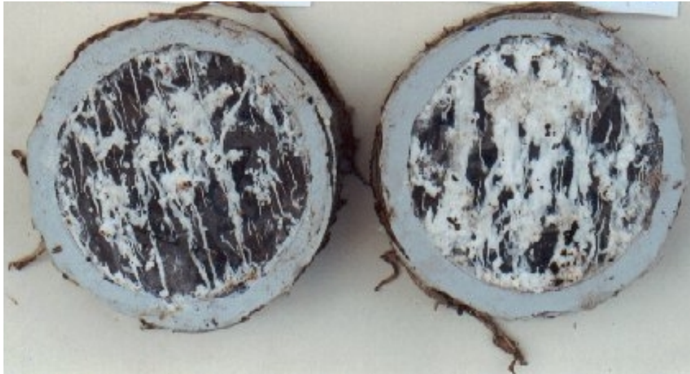
Figura 37 Visualização das faces dos corpos-de-prova expostas a solução com cloretos
